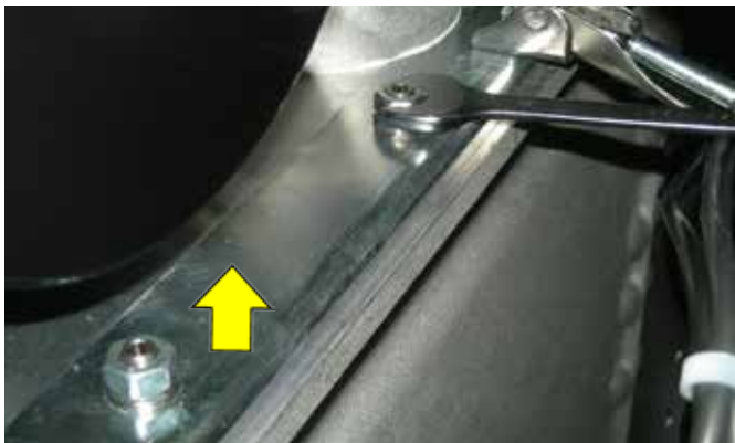
- Egy 13 mm-es csőkulccsal/villáskulccsal távolítsa el a „B” csavarokat, és távolítsa el a rögzítő lemezeket.
